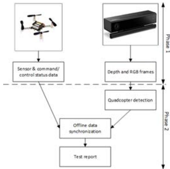
Fig. 10. Rularea testelor, achiziția de date și prelucrarea datelor offline
